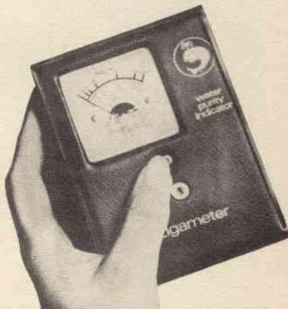
Fig. 1 - Elgometer, misuratore della purezza dell'acqua mediante la misura della sua resistenza e della conducibilità.
