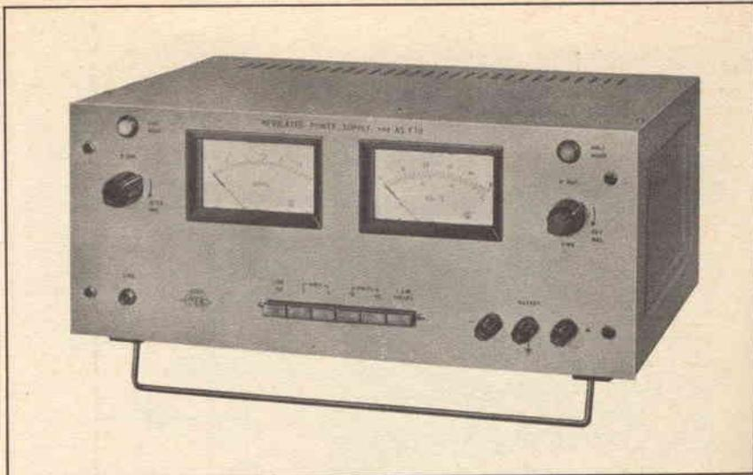
Fig. 6 - Alimentatore stabilizzato TES, modello AS 670 per tensioni da  $0$  a  $50 \text{ V}_{\text{cc}}$ , fino a  $3 \text{ A}$ .
